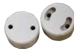
指先ほどの大きさのセラミックス部品に穴を開け、さらに穴の途中から曲線の溝を彫る。職人の高度な技術が光る
