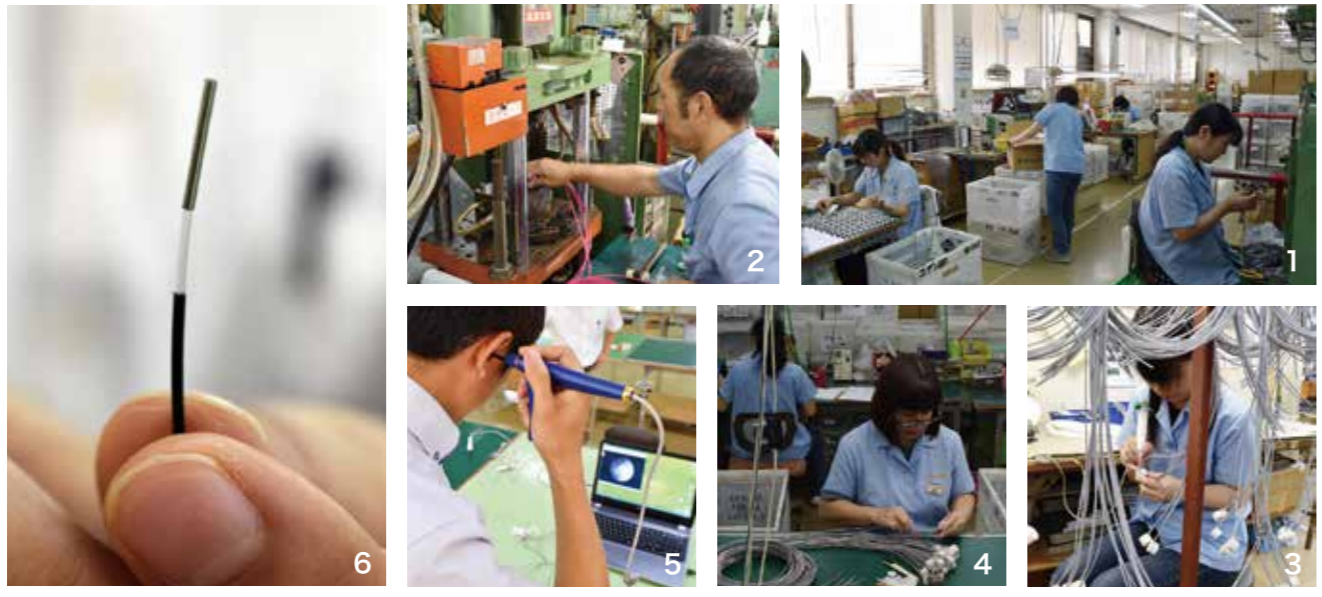
1) コデンでは女性が多く活躍している 2) ハーネスの成形。電線と蛍光灯が接続するソケット部分が作られる 3) 電線とソケットのわずかな隙間から水が入らないよう、防水ボンドを塗布する。コデンで作られたハーネスは、コンビニやスーパーのショーケースに使われることが多い 4) パリ（素材を研磨した際に生じる突起）やキズがないかを目視し、通電検査を行う 5) イヤスコープ MARK II を使用してみる。目の前のパソコンに自分の耳の中が映る 6) イヤスコープの光ファイバー。この先端にカメラレンズを装着する
