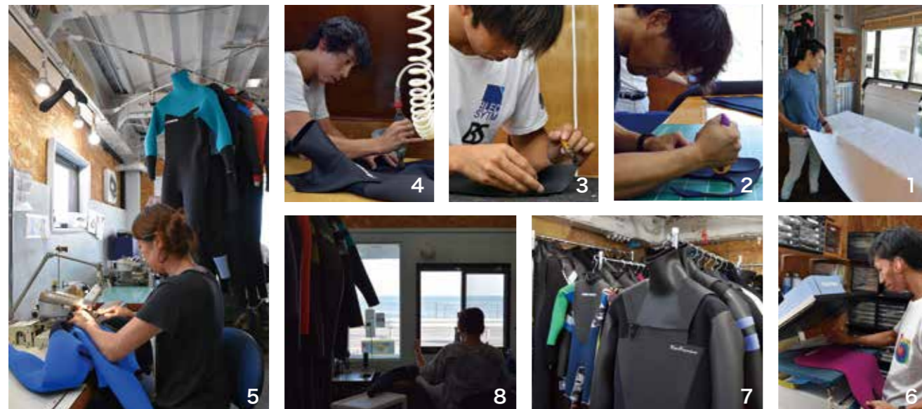
1) 受注データをパソコンに入力し、各パーツ型を印刷する 2) 型を元にスーツ生地をカットする 3) カットしたパーツの断面にボンドを塗る。生地が水分を吸うため二度塗る 4) ボンドが乾ききる直前でパーツを立体的にくっつけ、エアニッパーの圧力でギュッと接合させる 5) 接合部分を縫う。上下に貫通させると浸水に弱くなったり、着心地に影響するため、左右に縫い込む特殊なミシンを使う。糸のパリエーションも豊富だ 6) オーダーに応じてスーツにロゴマークを転写する 7) 完成したウエットスーツ 8) 作業場からは部原海岸を一望
