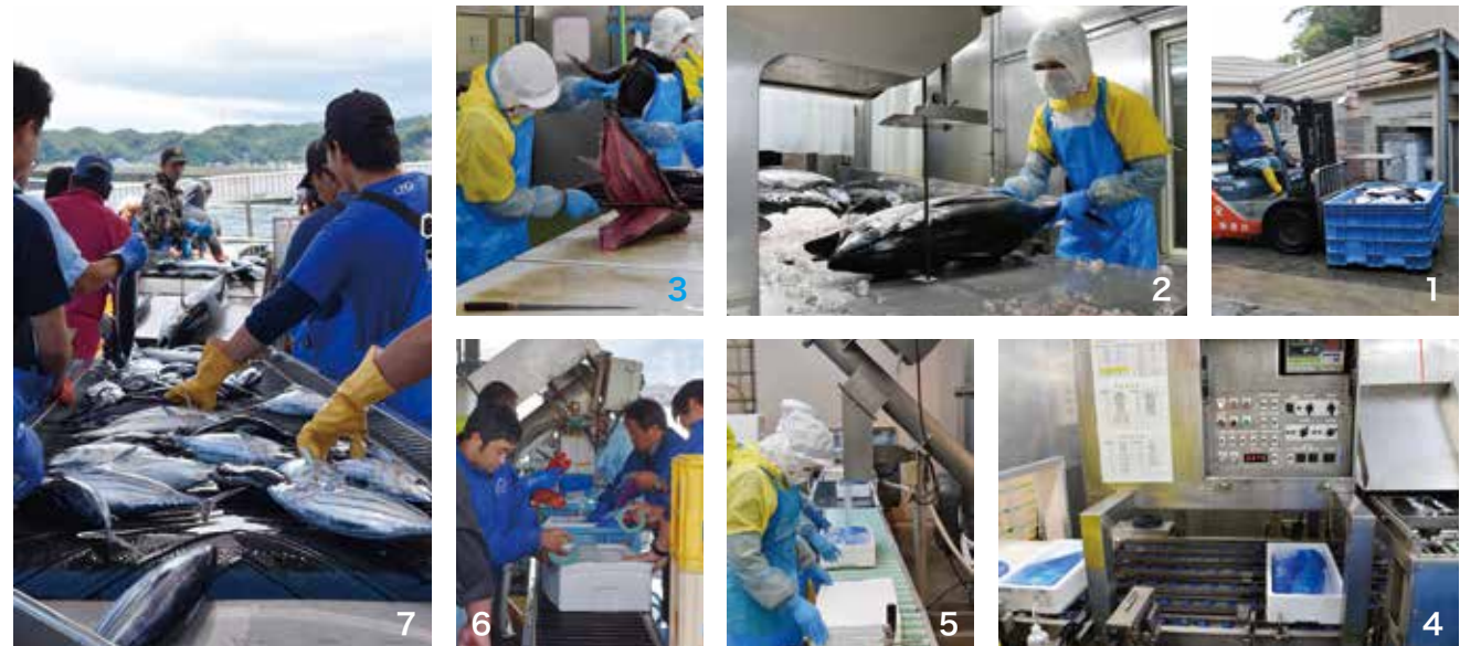
1) ピンチョウマグロを勝浦工場へ運ぶ 2) マグロの頭を切り落とす 3) マグロをさばっていく。産地で大量に下ろすことで必要な部分だけを配送でき効率的。出荷先での作業軽減にもつながる 4) フィレの重さを計って容器に重量・産地情報などを印字する…という工程を瞬間でこなすこの機械により、作業は大幅に効率化。導入前は人の手で秤に載せ、チョークで情報を記載していた 5) 流れ作業で氷詰まで行える 6) キンメダイの箱詰め作業 7) 高知県黒潮町の漁船が来船しカツオの水揚げをサポート。漁船との信頼関係は最も重要
