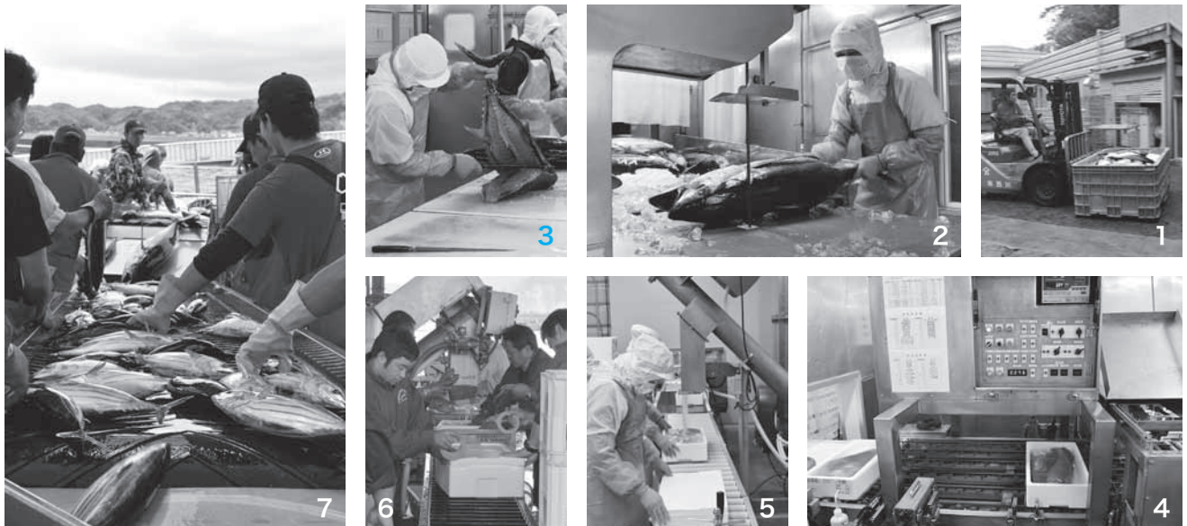
1) ピンチョウマグロを勝浦工場へ運ぶ 2) マグロの頭を切り落とす 3) マグロをさばいていく。産地で大量に下ろすことで必要な部分だけを配送でき効率的。出荷先での作業軽減にもつながる 4) フィレの重さを計って容器に重量・産地情報などを印字する…という工程を一瞬でこなしてしまうこの機械により、作業は大幅に効率化。導入前は人の手で秤に載せ、チョークで情報を記載していた 5) 流れ作業で氷詰まで行える 6) キンメダイの箱詰め作業 7) 高知県黒潮町の漁船が来船しカツオの水揚げをサポート。漁船との信頼関係は最も重要
