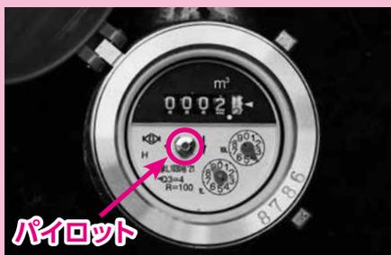
「パイロット」が回転している場合は漏水の疑いがあります。応急処置としてメーターボックス内の栓(バルブ)を右に回すことで水を止めることができます。
