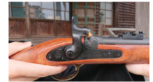
⑪撃鉄が雷管を叩き点火・発射 される
