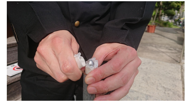
④弾丸を包み紙ごと銃身に押し込み、 余分な紙包みをちぎり捨てる
