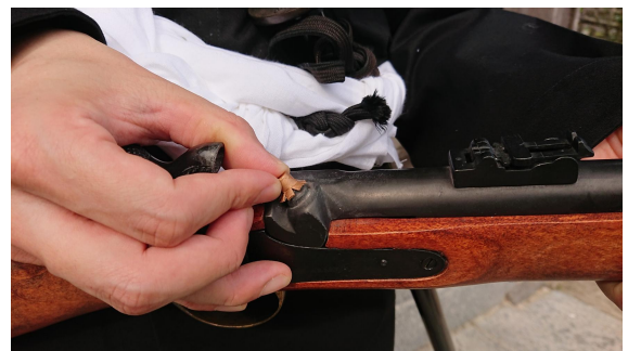
⑧銃身内の火薬に通じる小穴 「火門座」に雷管を被せる
