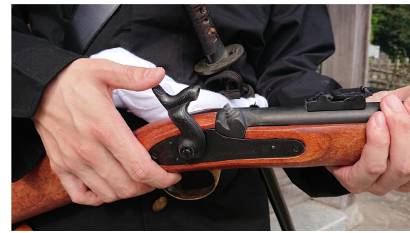
⑥撃鉄を半分起こす(この状態では、万 一引き金に触れても撃鉄が落ちない)
