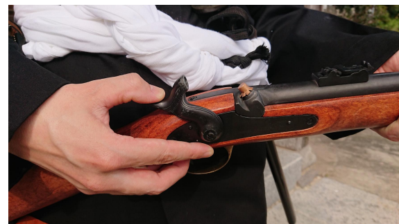
⑨撃鉄を完全に起こす (これで 初めて引き金と連動する)
